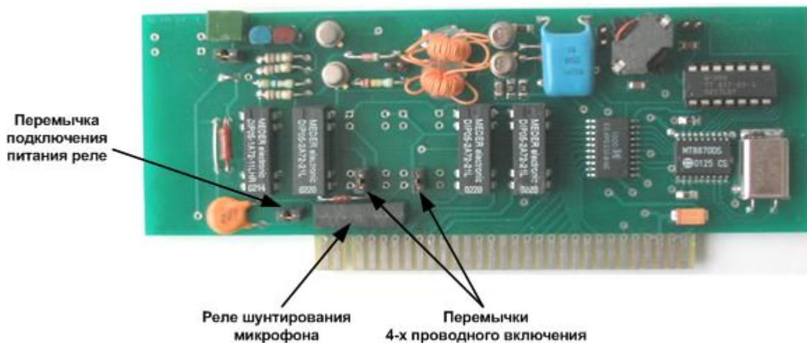
Рис. 12 Плата D52\_4 4-х проводн.
