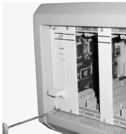
Рис. 33 Закрепляем ЦП 4.24 винтами
