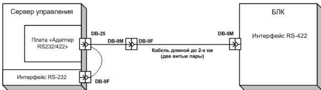
Рис. 12 Схема соединения БЛК и сервера по последовательному интерфейсу RS-422 через адаптер RS232/422 (РИНО.301411.232-000)
