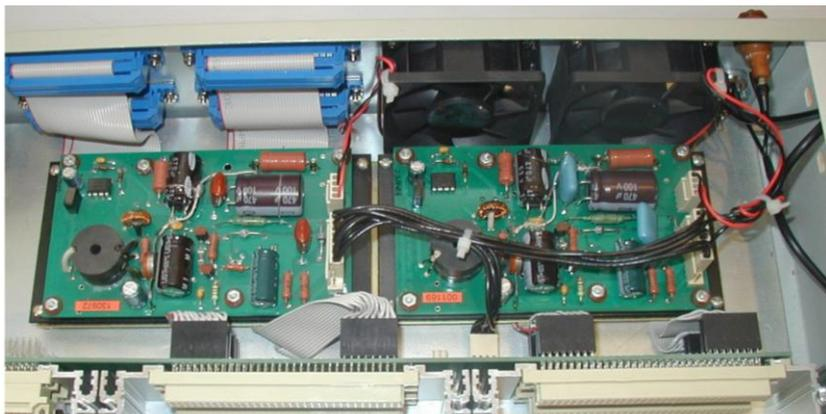
Рис. 4 RNG-360. Размещение и подключение блоков питания Cnv60\_243 v1.1
