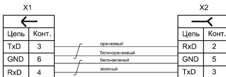
Рис. 16 Кабель интерфейса RS-232 (ПК/RNG-360). Схема электрическая
