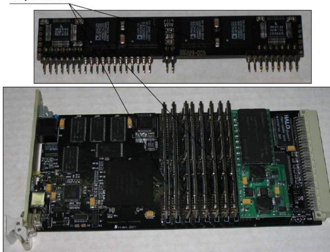
Рис. 5 Модуль DSP4.2 (верхняя часть рисунка) и плата Интерлинк 3.03 (нижняя часть рисунка) с восьмью модулями DSP4.2
