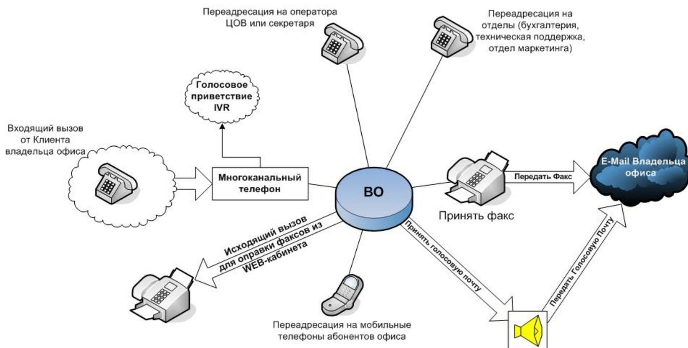
Рис. 1 Структурная схема обработки вызова ВО
